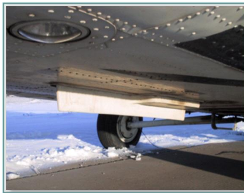
Рис. 9.97. Рамочная и ненаправленная антенны
